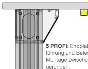
**5 PROFI:** Endplatten mit Leitungsdurchführung und Befestigunglöcher für die Montage zwischen PROFI Fussverlängerungen.
