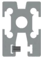
Bürstenleiste für die optimale Geräuschdämmung und Fixierung des Panels.
