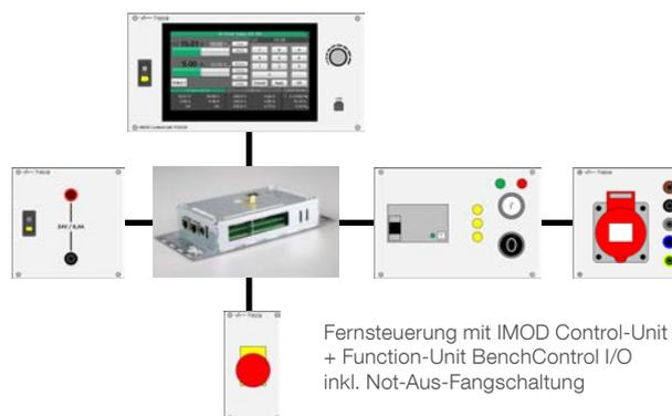
Fernsteuerung mit IMOD Control-Unit + Function-Unit BenchControl I/O inkl. Not-Aus-Fangschaltung
