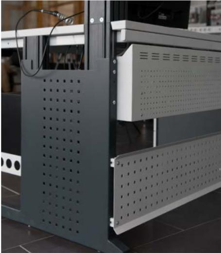
Platzsparende und geschützte Untertisch Aufbewahrung der teilweise großen und schweren Function-Units des IMOD- Gerätesystems (besonders AC-Quellen und Labornetzteile).
