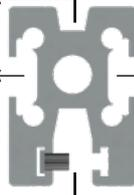
Vorderseite mit Nut zur flexiblen Befestigung von Halterungen über die gesamte Breite.
