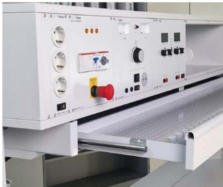
Schublade mit integriertem Kabelrechen
