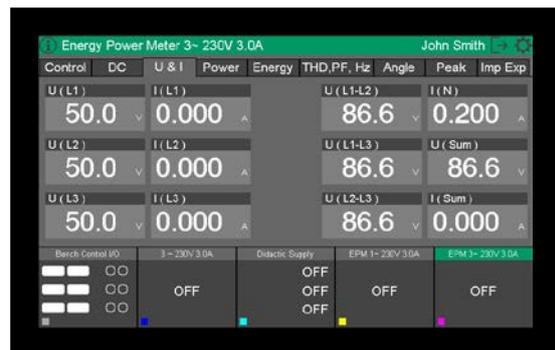
Anzeige aller Spannungen und Ströme
