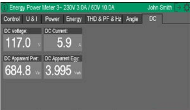
AC/DC-Quellen mit einer umschaltbaren Ansicht mit den DC-Werten.
