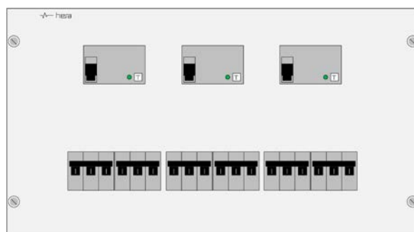
332.092.405: 19" Schülertischverteilung für 6x 3phasig mit FI (3x FI 4polig + 6x LSS 3xB16) 6HE
