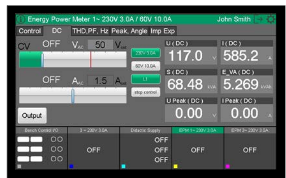
Die AC/DC-Quelle mit dem MF-Leistungsmessgerät um auch die DC-Werte messen und anzeigen zu können.
