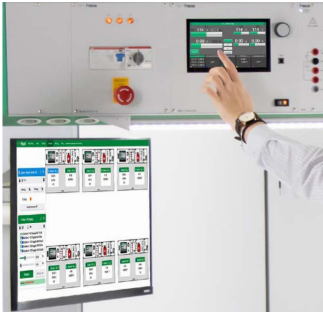
Auslesen und fernsteuern der IMOD Geräteserie mit der Software IMODdesktop und einem PC oder Laptop.
