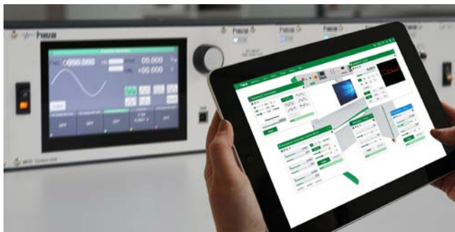
Freigeben und einschalten der Schülertische mit IMODdesktop auf dem Tablet, welches über einen AccessPoint mit der BenchControl Central verbunden ist.
