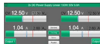
Doppelnetzteil Modi: Tracking
