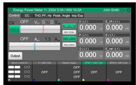
Die AC-Quellen in der Ausführung mit MF-Leistungsmessgerät.
