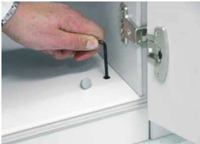
Einstellung der Bodenausgleichsschrauben
