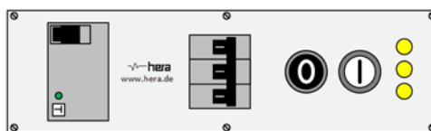
322.287.202: 3phasig mit B16-Automat, FI Typ B und 2stufiger Freigabeschaltung 8KP
