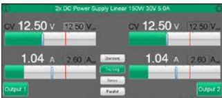
Doppelnetzteil Modi: Tracking
