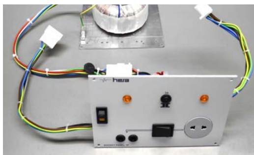
333.112.302 Trenntransformator mit umschaltbarem Ausgang
